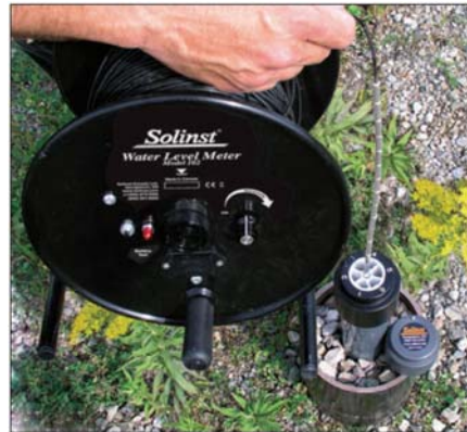
Solinst CMT®(멀티레벨 시스템)의 좁은 채널에서 지하수위 측정 장면
